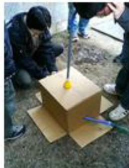
装置の性能を調べるため実際に毎分61の漏水を再現してダンボールで壁・床に見立てて実験を行った。実験結果は以下のようにになった。
